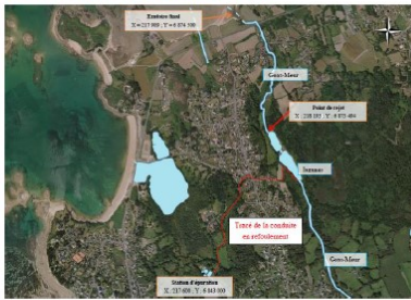
Figure 1-1 : Localisation de la STEP, du ruisseau de Goas Meur et de son exutoire
